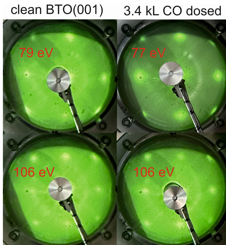
Figura 2.2: Difracție de electroni lenți pe suprafața curată de BaTiO 3 (001) și după dozare de CO. Energiile electronilor sunt indicate pe fiecare imagine [67].
